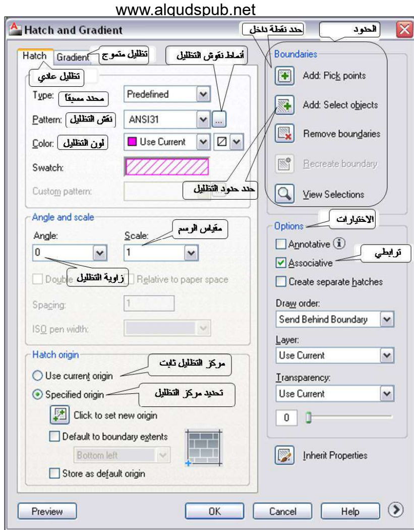
شكل 5.9: صندوق الحوار «التظليل والتدرج» Hatch and Gradient لنمط تظليل قياسي
